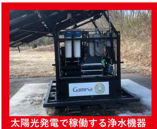
太陽光発電で稼働する浄水機器
